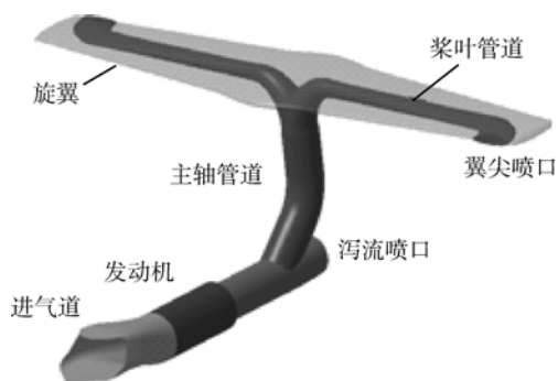
图1 典型喷气旋翼系统 Fig.1 Typical tip-jet rotor system
